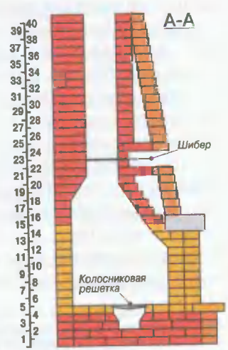
Рис. 3. Разрез камина
