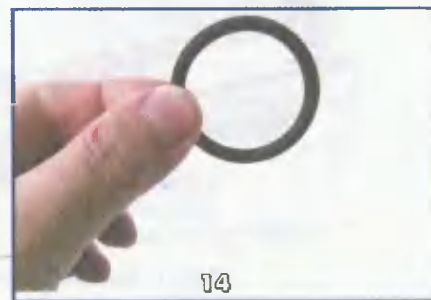
Перед прочисткой бака запаситесь новой резиновой прокладкой под блок с ТЭНами. Если старая прокладка находится в удовлетворительном состоянии, то менять ее не обязательно
