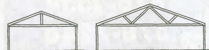
Ферма с пересекающимися элементами (пролет под фермой достигает 12 м), приподнятый нижний пояс которой позволяет увеличить объем перекрываемого пространства
