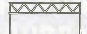
Ферма с пересекающимися элементами (пролет под фермой достигает 12 м), приподнятый нижний пояс которой позволяет увеличить объем перекрываемого пространства
