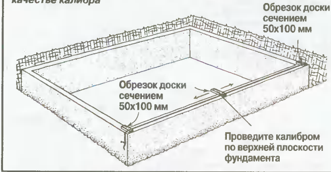
Рис. 3. Проверка верхней плоскости фундамента. Натянув шнур по верхней плоскости фундамента, можно выявить впадины и «горбы». Закрепите шнур над блоками, вырезанными из доски «пятидесятки», и воспользуйтесь таким же блоком в качестве калибра
